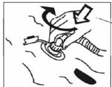
Figura 2.4 – Innesto a pressione della tubazione alla valvola di gonfiaggio.
